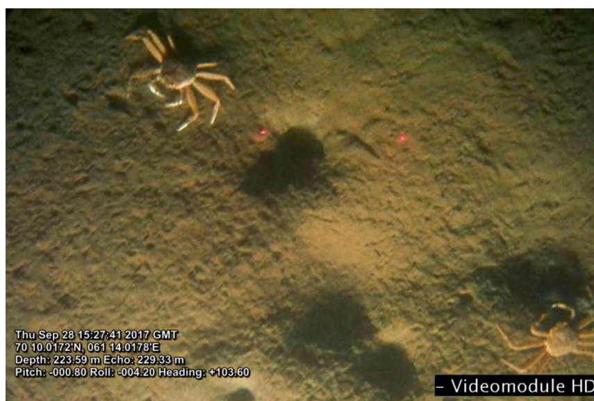
Рис. 2. Пример видеоизображения дна, полученного НПБА «Видеомодуль» в 69 рейсе НИС «Академик Мстислав Келдыш» в Карском море с титрами (в левом нижнем углу) и масштабными метками (две красные точки в центре)
