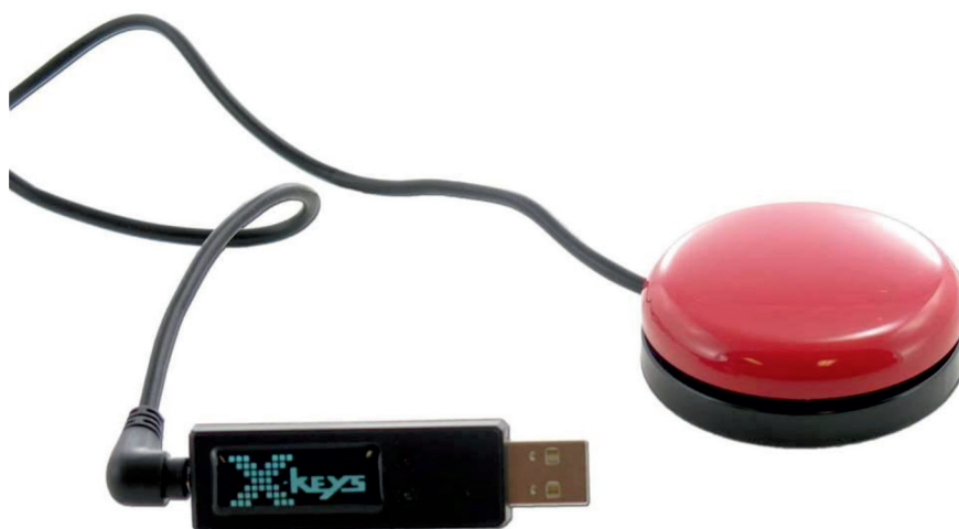
Рис. 3. Специализированная кнопка для ускорения набора (применяется для пациентов, которые не полностью обездвижены)
