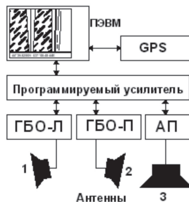
Рис. 1. Структура процесса сбора информации, для комплексов ЛГД ИО РАН: GPS – приемник КНС, ГБО-Л и ГБО-П – каналы ГБО левого и правого борта, АП – канал АП, 1, 2, 3 – антенны ГБО-Л, ГБО-П и АП
