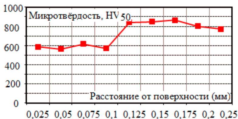
Рис. 5. График результатов замеров микротвёрдости в единицах HV 0,05 по глубине
