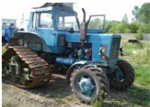
Рис. 1. Трактор класса 1,4 с опцией полугусеничного хода
