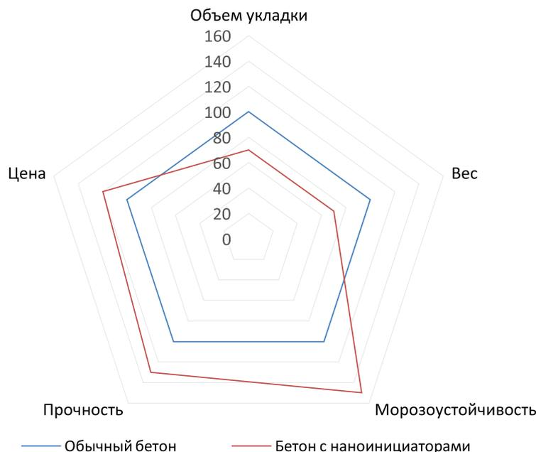
Рис. 2. Влияние нанопластификаторов на эксплуатационные характеристики бетона
