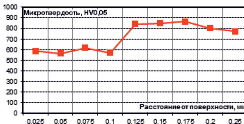
Рис. 8. График результатов замеров микротвёрдости в единицах HV0,05 по глубине
