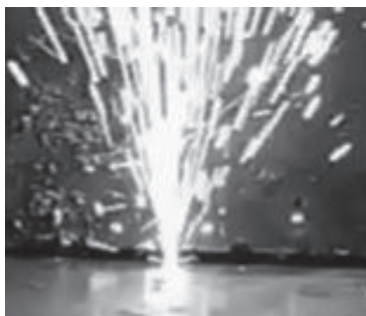
Рис. 5. Фотография процесса лазерной наплавки металла
