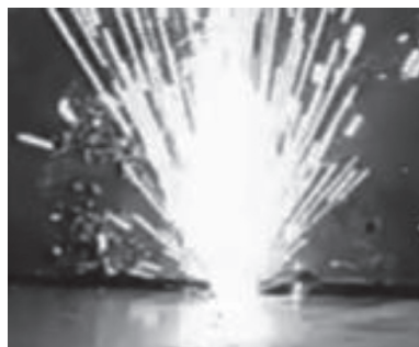
Рис. 6. Фотография процесса лазерной закалки металла
