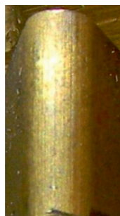
Рис. 3. Фото поверхности зуба фрезы после обработки воздействия импульсного лазерного излучения. 1 – зона воздействия
