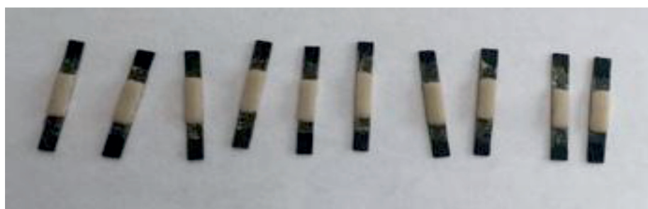
Рис. 3. Фотография образцов, предназначенных для проведения испытаний на изгиб металлического сплава Stomet 2kz и толщине керамического слоя «Dizain» равной 1 мм
