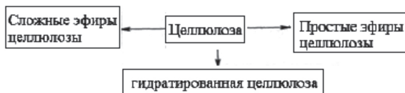
Рис. 3. Схема получения полимерных материалов из целлюлозы
