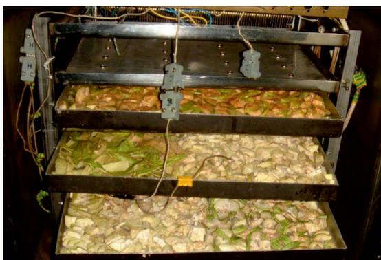
Рис. 1. Измельченные и замороженные плоды фейхоа в противнях при загрузке в сушильную камеру лабораторного стенда СВП-0,36
