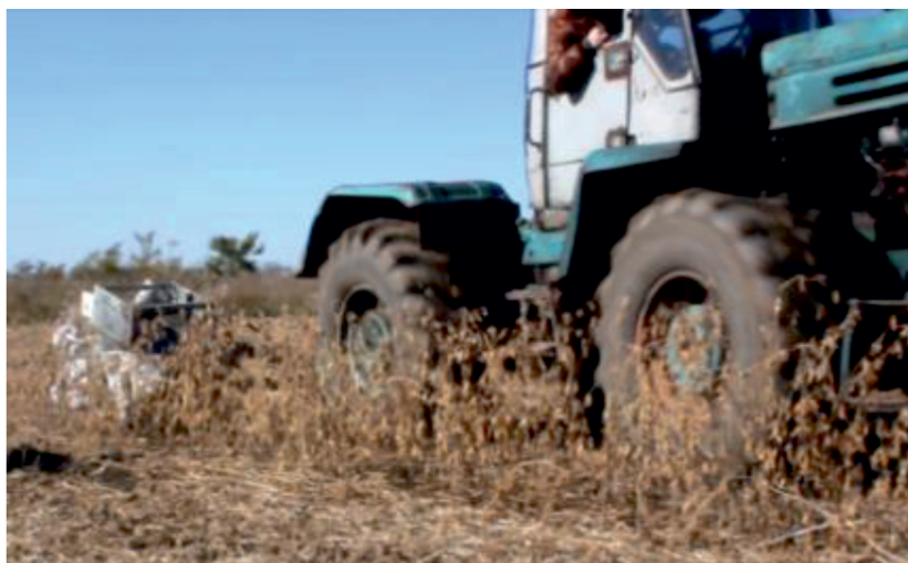
Рис. 2. Работа Т-150К с экспериментальной очёсывающей жаткой на опытном поле
