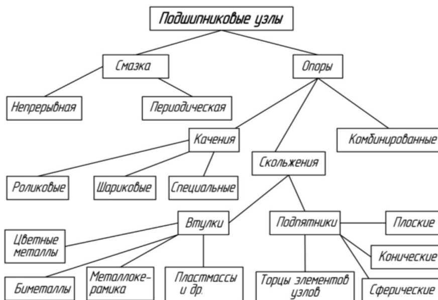
Рис. 2. Схема классификации конструкций подшипниковых узлов РИ
