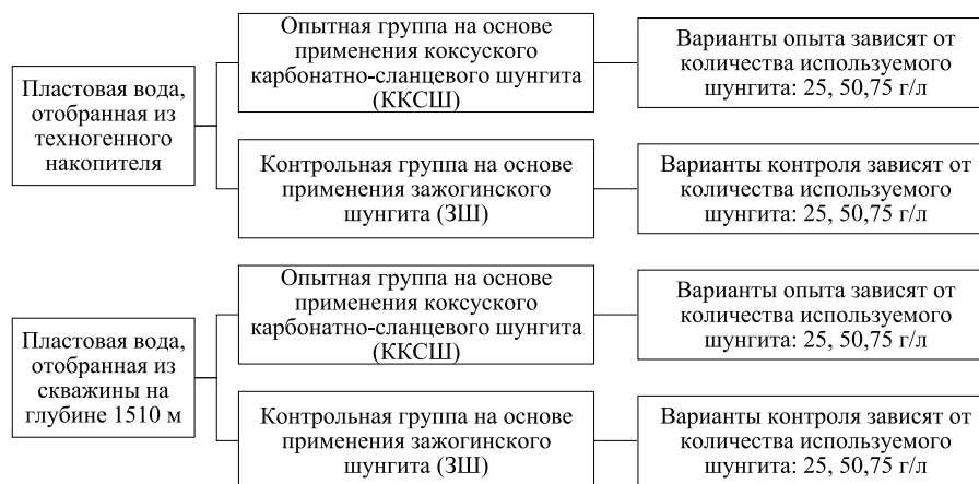
Схема проведения научного эксперимента по биоремедиации пластовой воды
