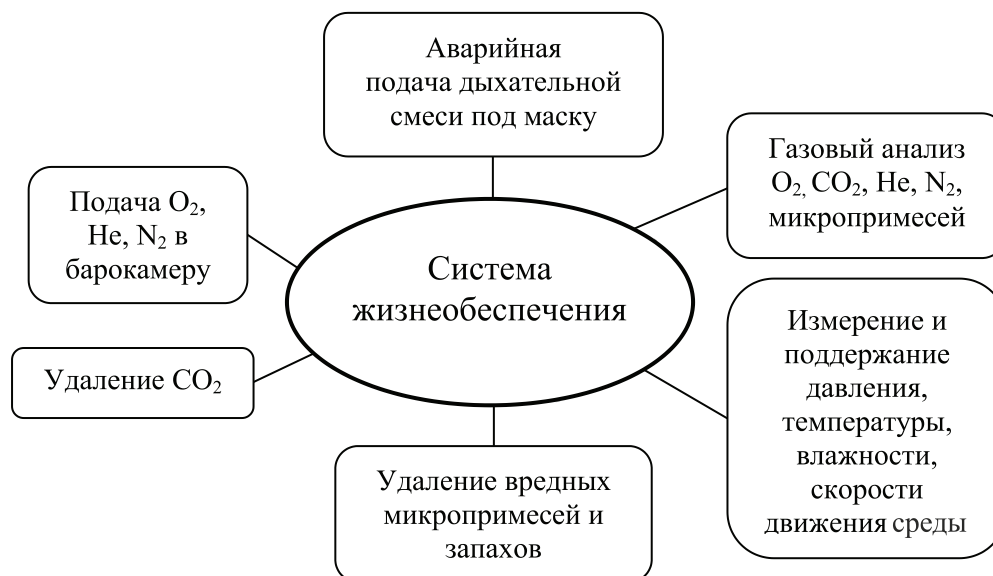
Структурно-функциональная схема системы жизнеобеспечения с основными подсистемами формирования газовой среды и микроклимата в барокамере
