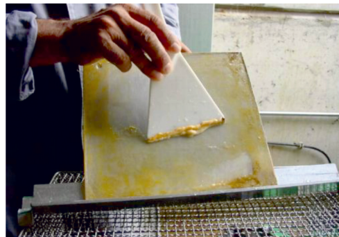
Сбор биомассы с образца полимерного материала согласно тесту DVGW Arbeitsblatt W 270
