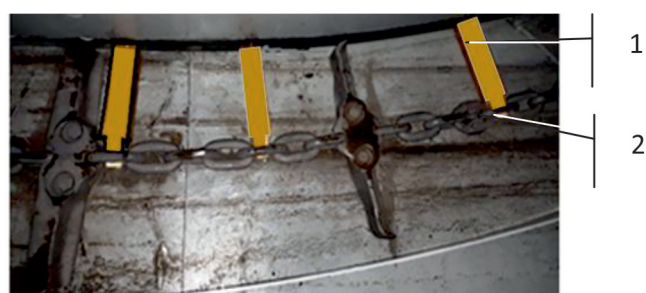
Рис. 2. С несколькими дополнительными скребками: 1 – скребок, 2 – контактная зона
