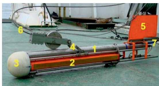
Рис. 2. Буксируемый глубоководный носитель ГБО «Мезоскан-М»/«Мезоскан-Т»: 1 – прочный корпус (труба) бортового электронного блока; 2 – антенна ГБО; 3 – груз-утяжелитель; 4 – узел подвески; 5 – стабилизатор; 6 – кабель-трос; 7 – герметичный ввод
