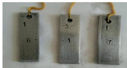
Рис. 1. Образцы перед началом выдержки в растворе
