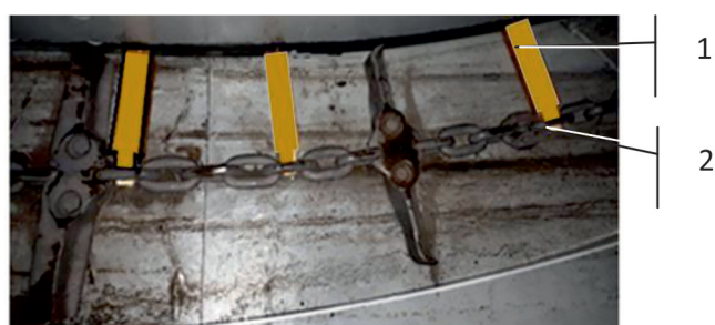
Рис. 2. С несколькими дополнительными скребками: 1 – скребок, 2 – контактная зона
