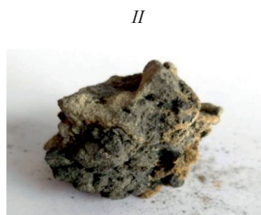
Рис. 10. Продукты электроплавки: I – ферросплав, II – карбид кальция
