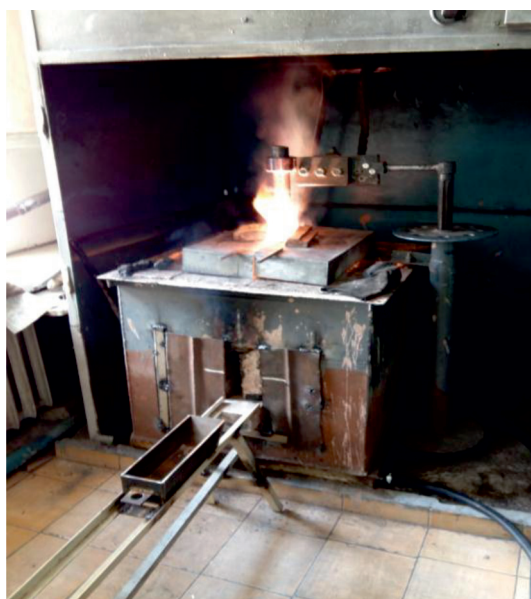
Рис. 9. Укрупнено-лабораторная электротермическая установка
