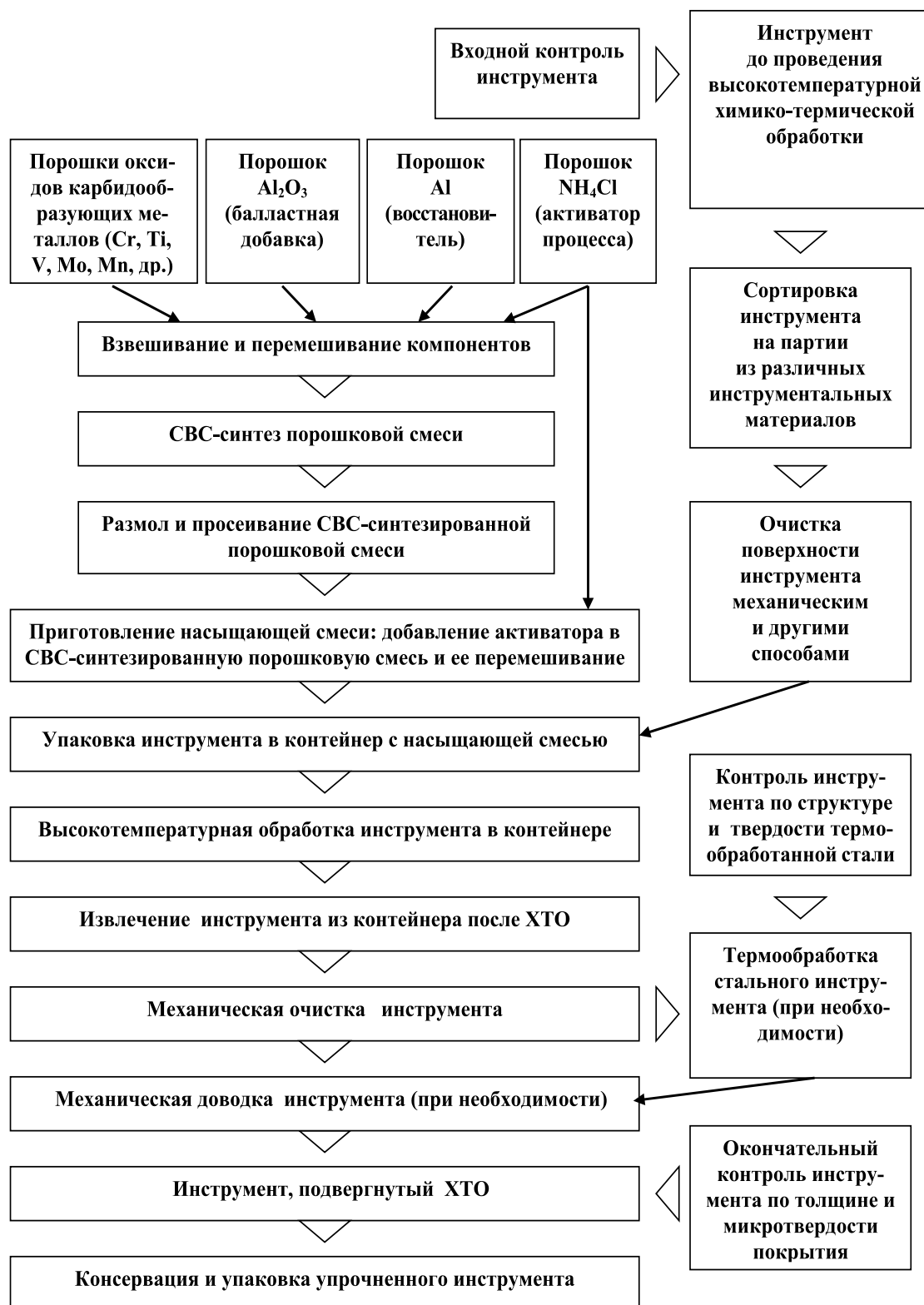
Рис. 1. Блок-схема технологических операций технологического процесса химико-термической обработки (ХТО) инструмента
