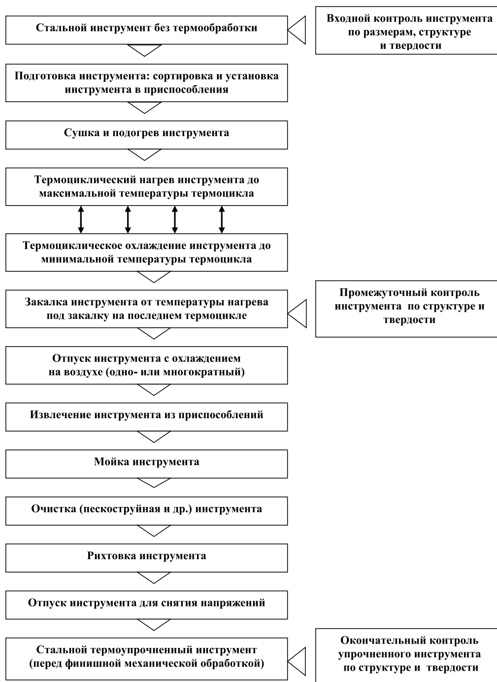
Блок-схема технологических операций предлагаемого процесса упрочняющей термоциклической обработки (УТЦО) стального инструмента
