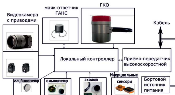
Рис. 3. Блок-схема подключения сенсоров, которыми оснащен ТНПА
