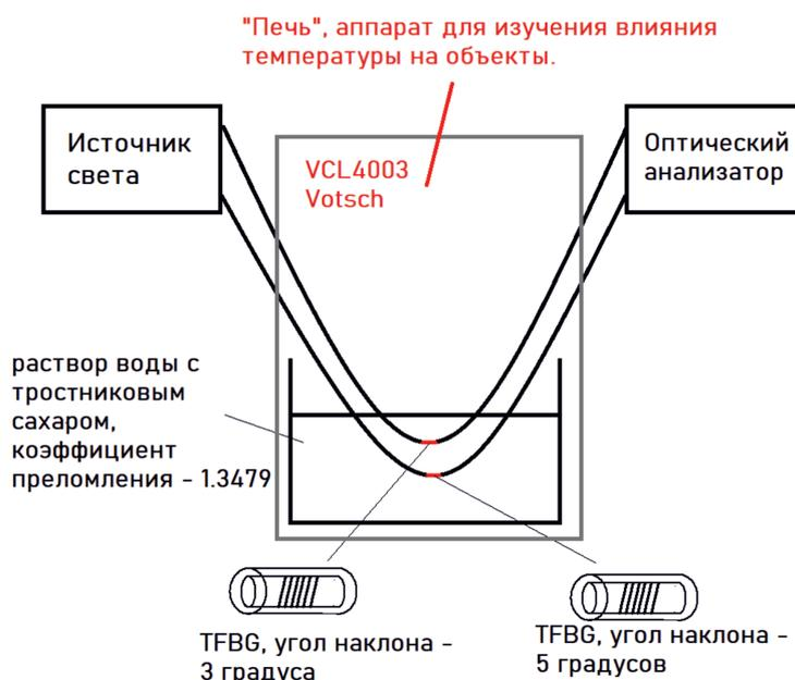
Рис. 1. Экспериментальная установка для исследования зависимости длины волны наклонной брэгговской решетки от температуры
