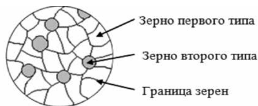
Рис. 4. Модель структуры стали, состоящей из двух типов зерен
