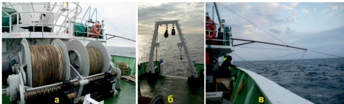
Рис. 3. Оборудование для спуска, подъема и буксировки геофизических приборов на НИС «Профессор Водяницкий»: а – кормовая траловая лебедка; б – кормовая П-рама; в – бортовой выстрел для буксировки излучателя и приемной антенны (косы) сейсмоакустического профилографа «Геонт-шельф»
