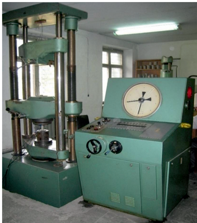
Рис. 1. Оборудование (пресс ЦДМ-100) для исследования образцов горных пород на одноосное сжатие
