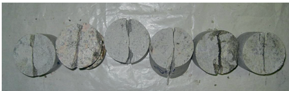
Рис. 4. Виды разрушения образцов горных пород по Бразильскому методу при одноосном растяжении
