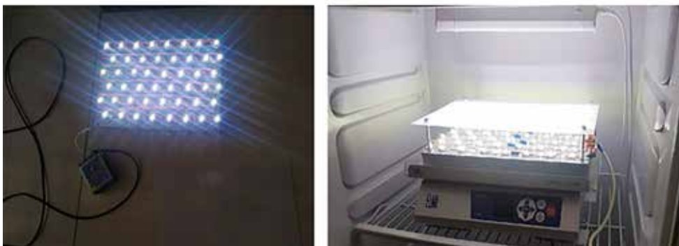
Рис. 2. Внешний вид светильника; светильник в термостате
