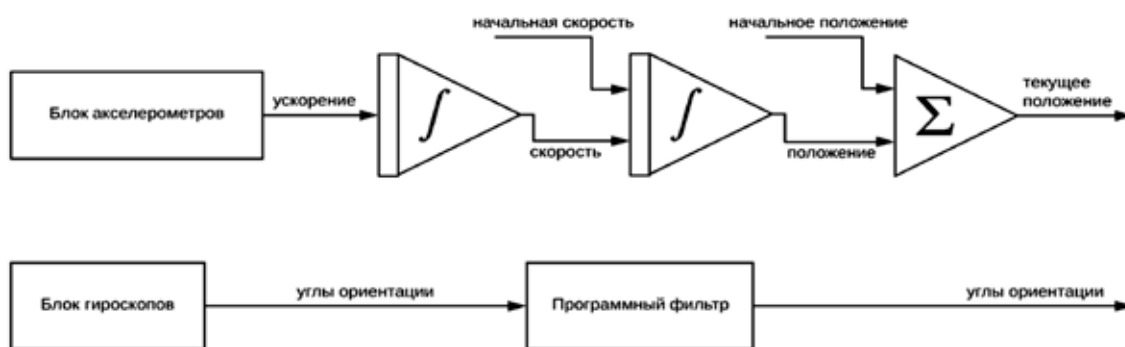
Рис. 1. Структурная схема инерциальной навигационной системы
