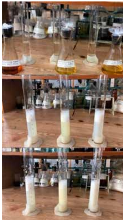
Рис. 3. Исследование пенообразующей способности ПАВ
