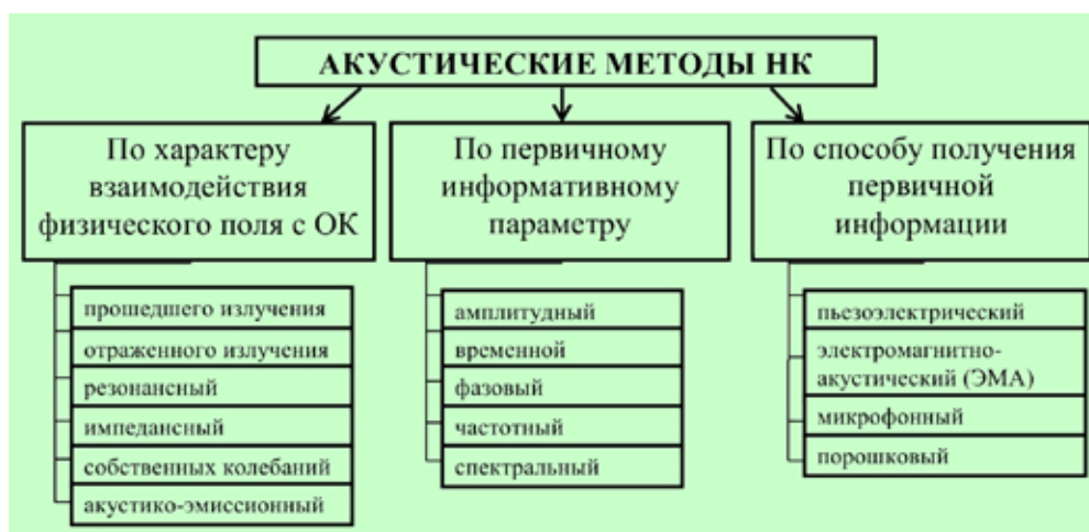
Рис. 3. Классификация акустических методов контроля по ГОСТ 18353-79
