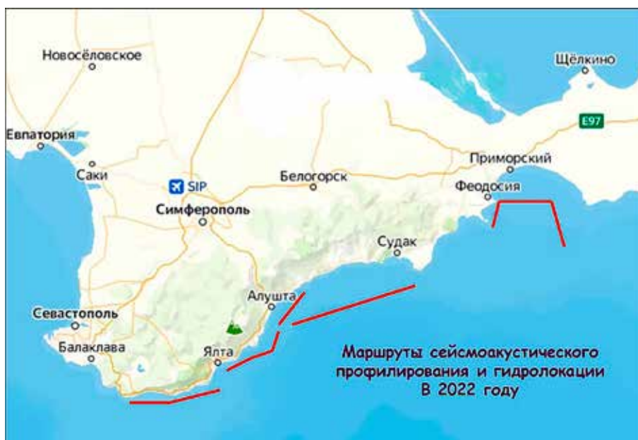
Рис. 1. Общая схема маршрутов сейсмоакустического профилирования, эхолотирования и гидролокации на шельфе Крыма в 2022 г.
