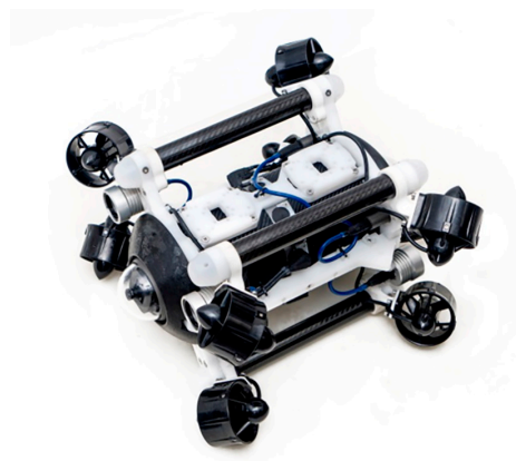
Рис. 2. 6- и 8-моторные версии ТНПА ГНОМ
