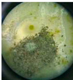
Рис. 4. Рост культуры гриба рода Aspergillus на поверхности шлака под микроскопом (суммарное увеличение \times 7,5 )
