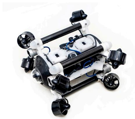
Рис. 2. 6- и 8-моторные версии ТНПА ГНОМ
